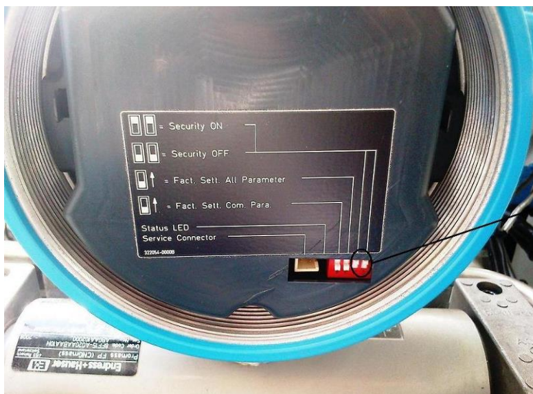
Obr. č. 11 Umiestnenie prepínačov v elektronike meradla
